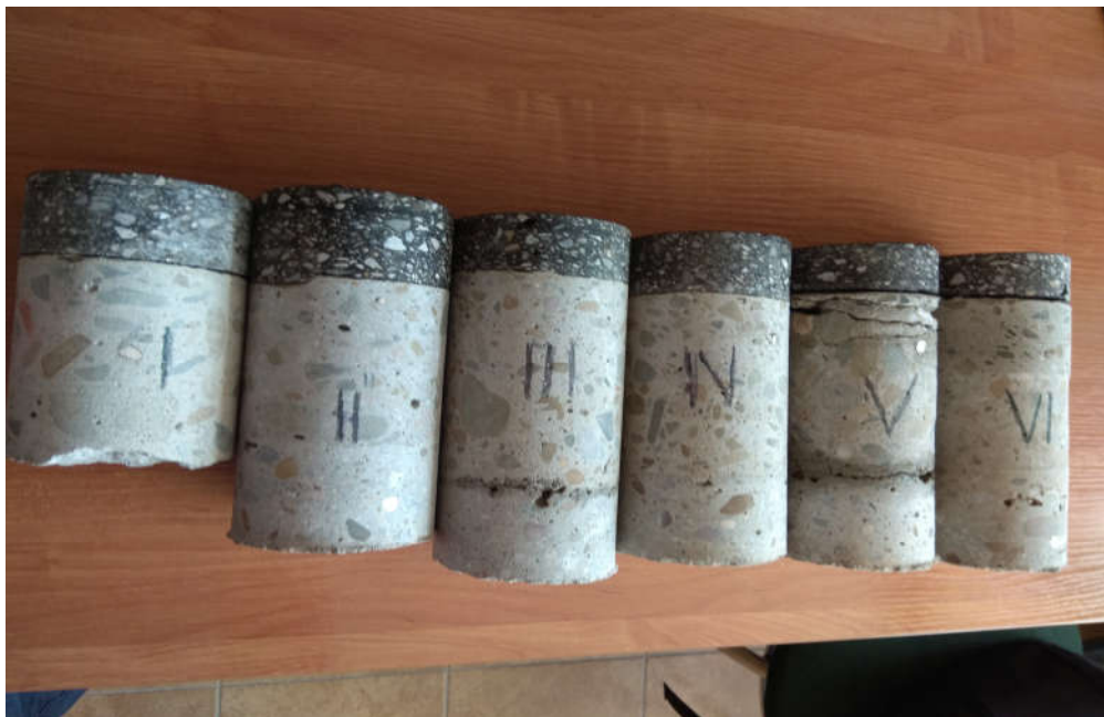
Zdjęcie 2: Wykonane odwierty - próbki
